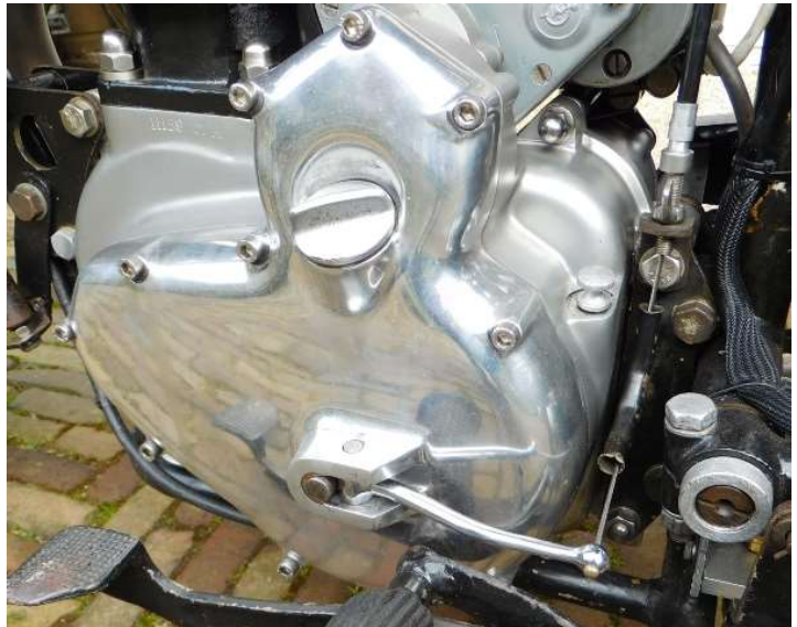
Als je de koppelingshendel inknijpt gaat -via de hevel- de as naar buiten en trekt aan de aandrukplaat -via het taatslager- waardoor de koppeling los komt.
