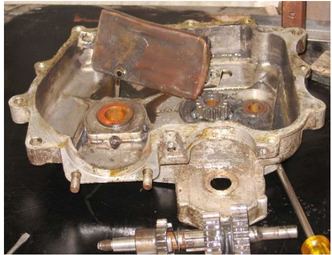
Dit blok had veel vet erin zitten. Waarschijnlijk omdat men dacht dat dit met versleten en rammelende assen beter smeert als dunne olie. En het minder lawaai maakt
