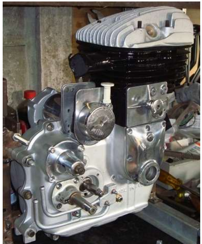
Alles moest oliedicht blijven, heel smal zijn tussen ketting en carter. Maar Albert Huijgens had het allemaal al eens uitgeplozen en hij was welwillend om mij met dit lastige probleem te helpen. En zijn oplossing van de oliepomp zelf, is nog wel het mooiste.
