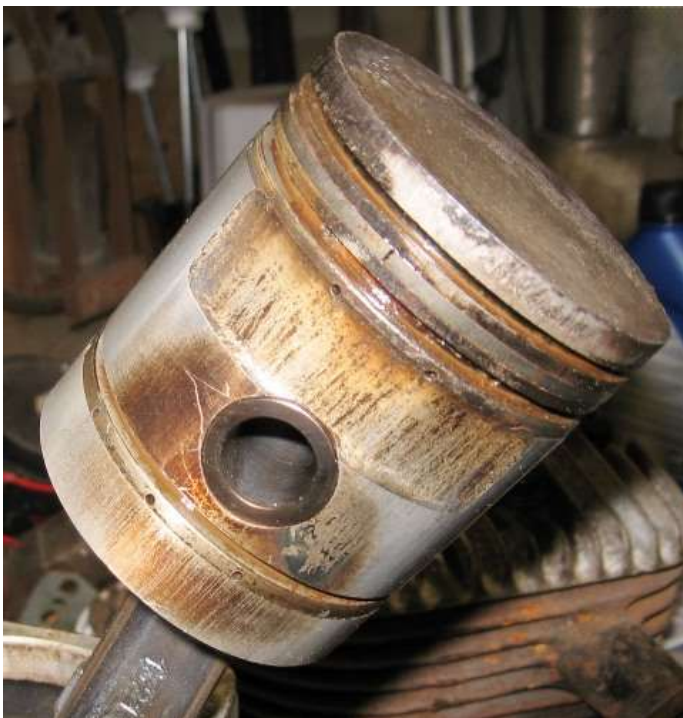
Een FN kwaliteitszuiger. Dit was mijn beste qua slijtage, maar viel te ver buiten de maat van een bruikbare cilinder
