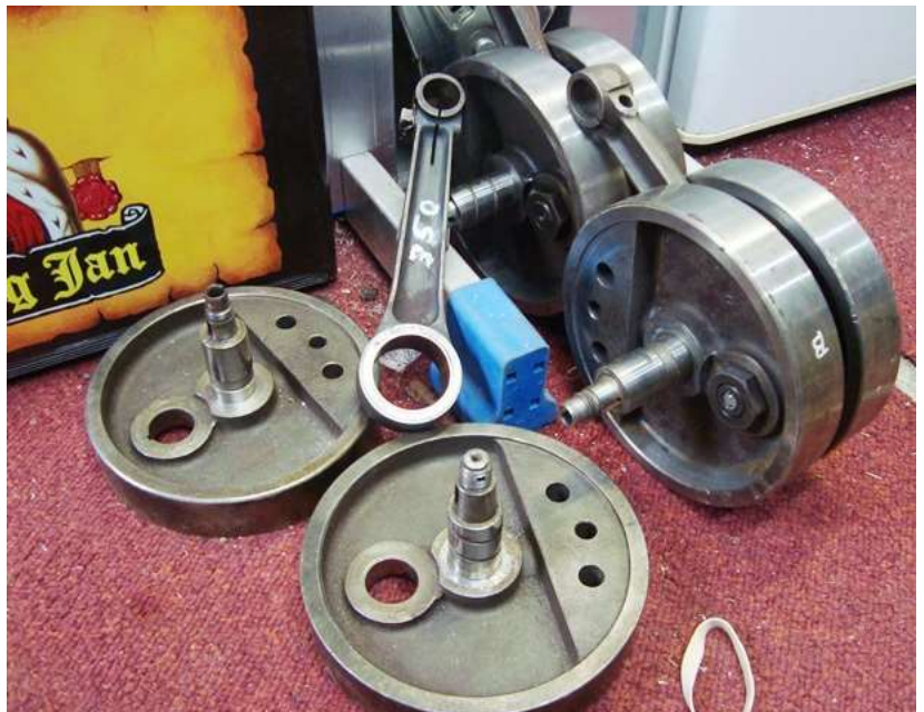
De krukas die uit elkaar ligt, zat bij een blok met een vastgelopen big-end.
