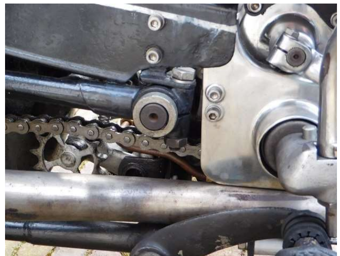
De teller annex kettingspanner zit op een moeilijk te bereiken plek onder de motor. Mogelijk dat hij daarom vaak vergeten werd om te smeren en dat menig wormoverbrenging een verkort leven heeft gemaakt.
