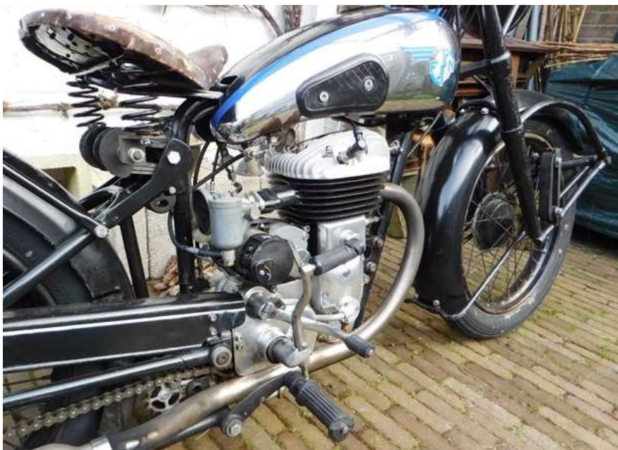
Figuur 1 Elke producent van een motor wilde opvallen met zijn merk. Het aanzicht van het blok was vaak bepaald door de techniek die men toe wilde passen. Maar het rijwielgedeelte kon wel een huismerk zijn. Iedereen zocht dat in voornamelijk het tankaanzicht. Een FN herken je meteen aan het achterste zakkende gedeelte van de tank. Je hebt geen embleem nodig om een FN te herkennen. Mooi he?
